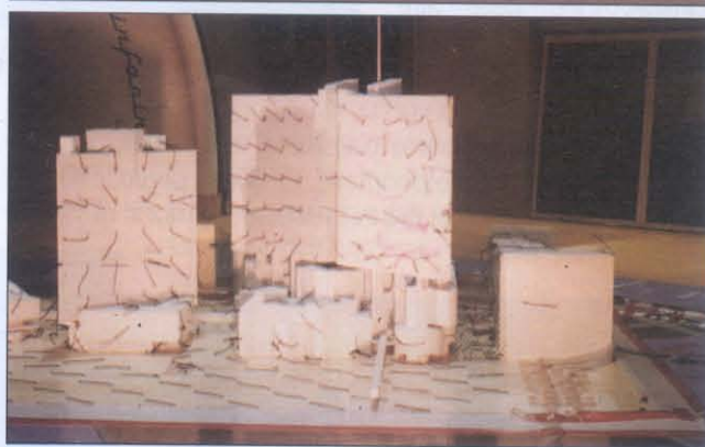
Vista in 3d della galleria del vento genovese (in alto); qui sopra prove sul modello di Corte Lambruschini, il complesso realizzato a Genova presso la stazione Brignole.
